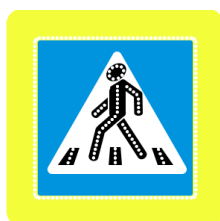
Рисунок 2.11.1 – Пример знака 5.19.1 на желтом фоне со световой индикацией
