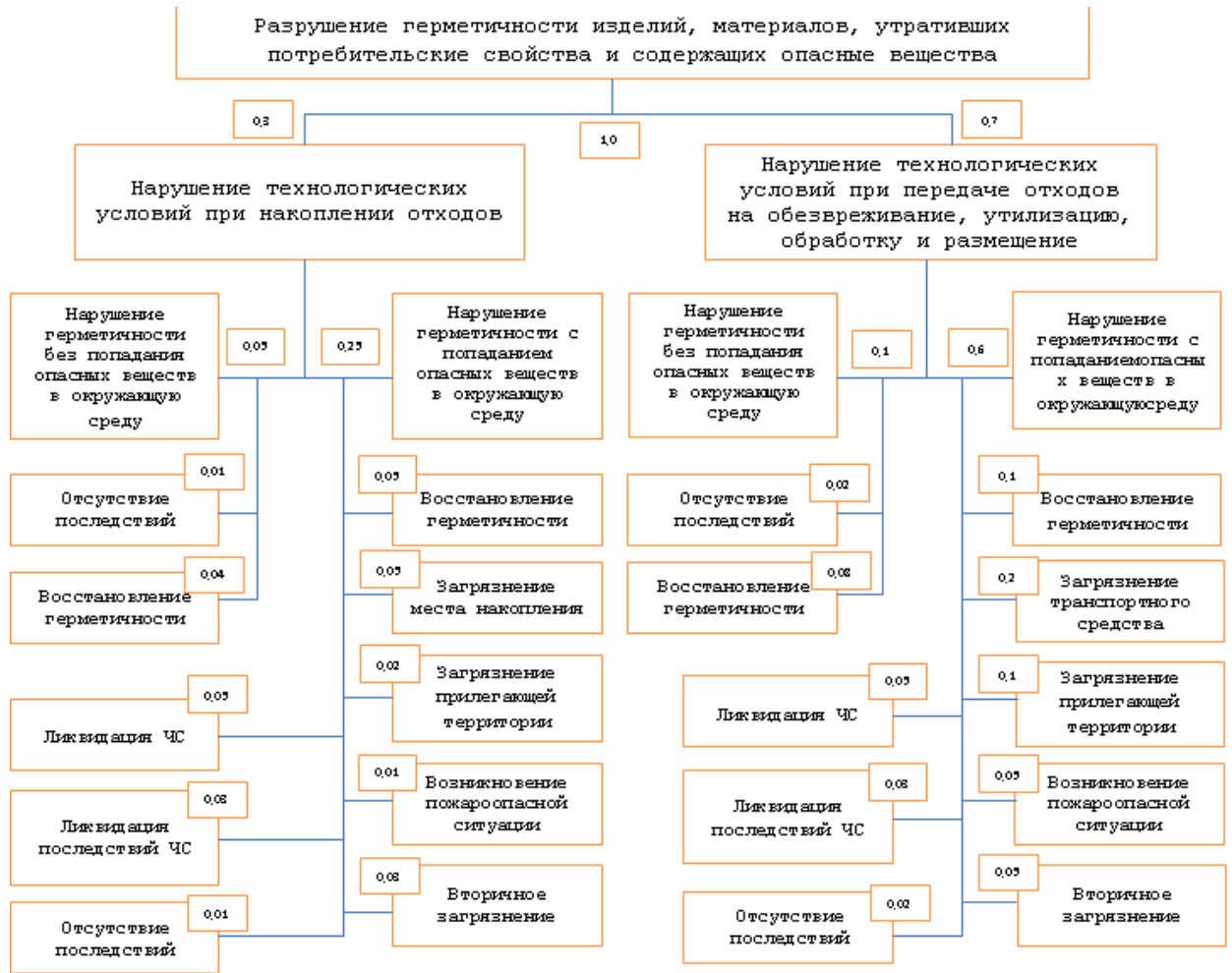
Рис. 9.6. «Дерево событий» ЧС, связанного с разрушением герметичности изделий, материалов, утративших потребительские свойства и содержащих опасные вещества
