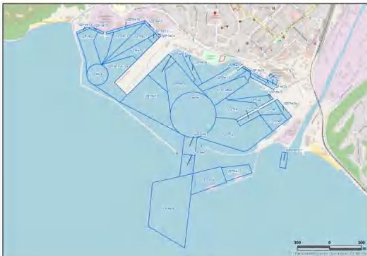
Рисунок 3.2 Участки дноуглубительных работ
